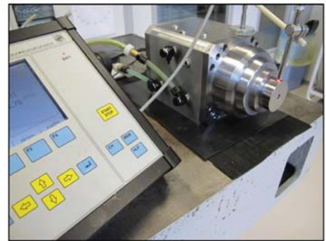
Feineinstellung der Wuchtgüte an der Spindel
