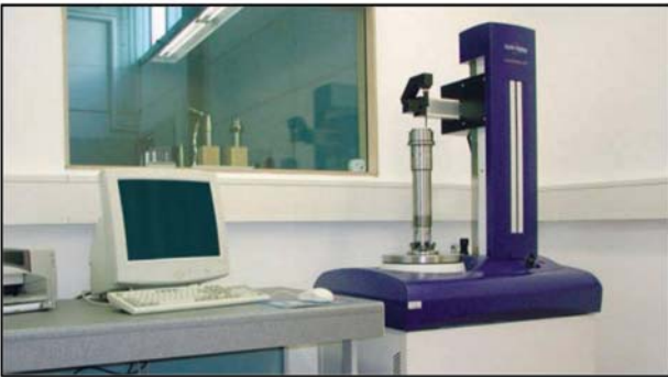
Rundlaufmessmaschine (zur Prüfung rotationssymmetrischer Teile einer Spindel)
