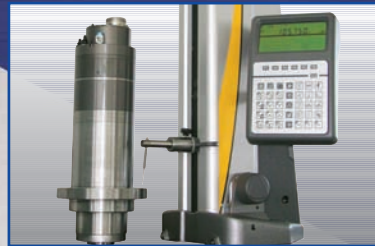
Höhenmessgerät. (Zur maßexakten Ermittlung der Höhenmaße im Mikrometerbereich). Height measuring unit. (for dimensionally exact determination of the height dimensions in the micrometer range).
