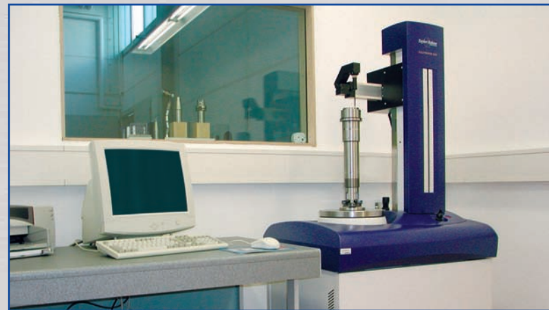
Auswuchtmaschine. Zur perfekten Rundlauf-Justierung. Balancing machine. For perfect concentric running adjustment.
